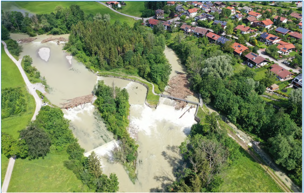
Abb. 38: Flutmulde der Mangfall bei Feldkirchen-Westerham: Die Wildholzrechen erfüllen ihren Zweck, aber auch am Westerhamer Wehr (rechts im Bild) kommt es zu starker Verkläusung
