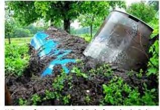
U-Boot aufgetaucht: In Bad Endorf wurde ein Erdgasspeicher aus dem aufgeweichten Boden gedrückt.
