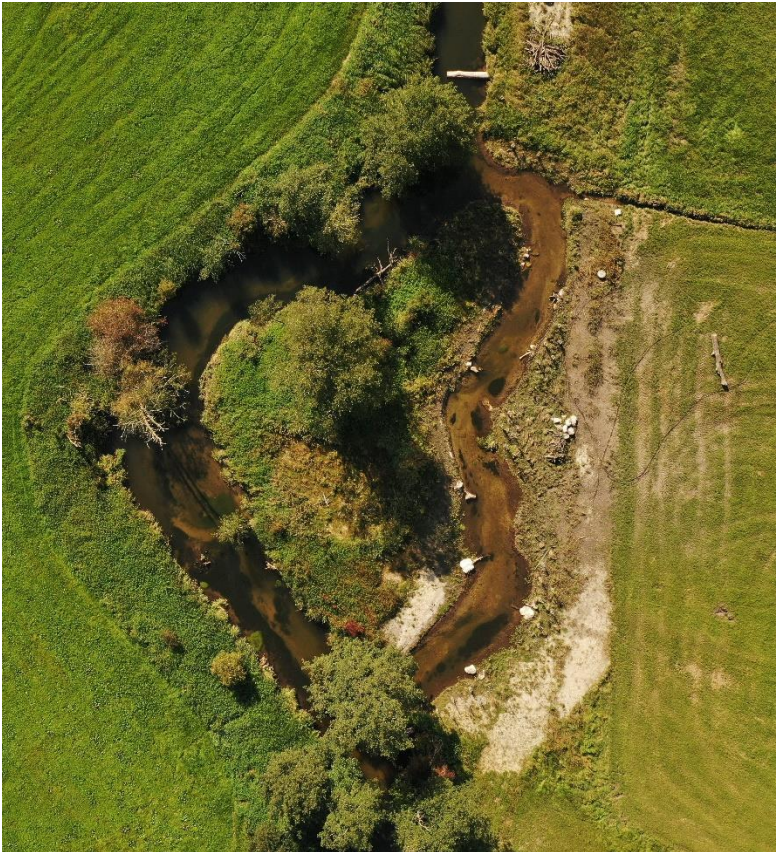
Abbildung 1: Beim Bauabschnitt 1 wurde unter anderem ein durchflossener Seitenarm als Jungfischhabitat geschaffen (Foto: Wasserwirtschaftsamt Rosenheim)
